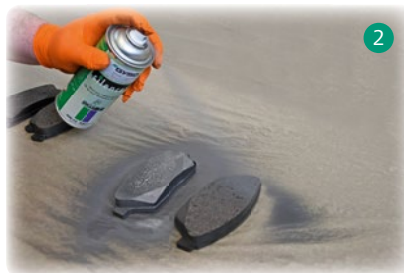
Silencer gleichmässig auf die Bremsbeläge aufsprühen.
