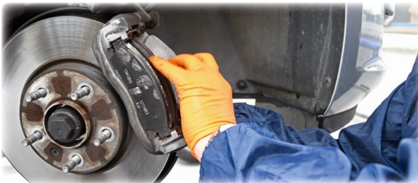
Silencer gleichmässig auf die Bremsbeläge aufsprühen.
